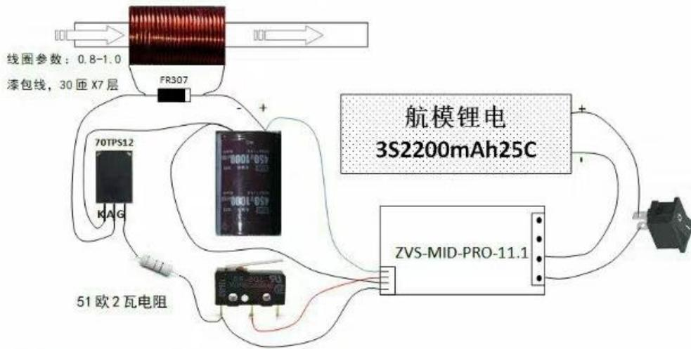
图 3.6 电磁炮连接实物图
